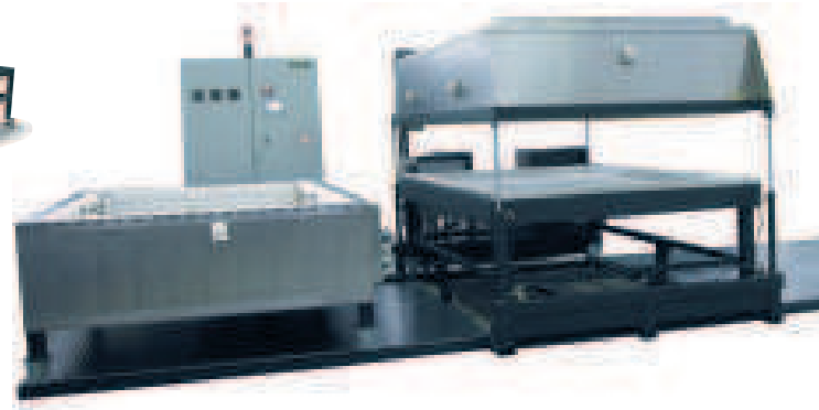
Fusing ve bombeleme işlemleri için öngörölmüş olan kombine tipi-fırın sistemi.
