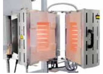
RS 100/250/11S modeli var olan bir kontrol sistemine tesis edilmek üzere, açılabilir tipte donatılmış olarak.
