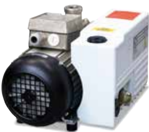
5 mbar'a kadar kaba vakumda ısı işlemleri için tek kademeli kanatlı çarklı pompa
