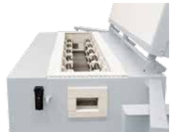
GR 1300/13 modelinin ikinci kapak ile ilave donanımlı fırın haznesi
