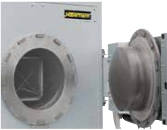
Retort (tüp) için hızlı bayonet kilidi, ek donanım olarak elektrikli tahrik sistemi ile de satılır
