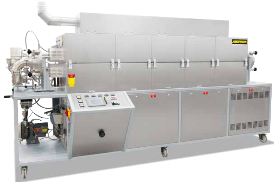
RS 250/2500/11S, beş bölümlü, tellerin yüksek vakum ve gazaltı atmosferde tavlınması için, hızlı soğutma ve davlumbaz dahil
