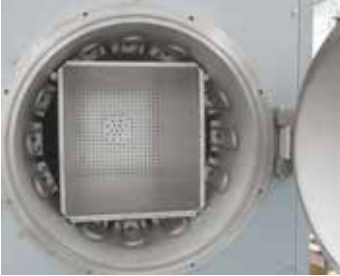
İç ısıtma NRA ../06 modellerinde
