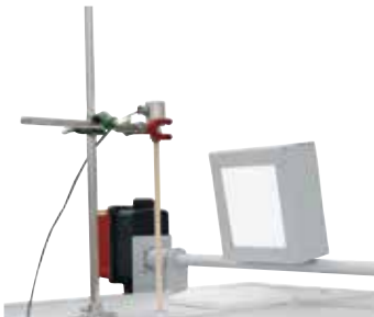
Ek donanım olarak statif ile birlikte atık hava klapesi ve şarj termo elemanı
