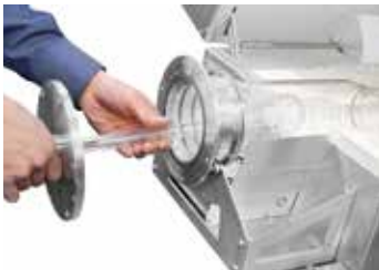
Tek tarafı kapalı kuvarslı cam boru için gaz izoleli kapatma tapası
