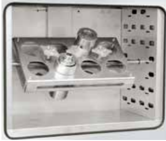
İlave donanım olarak, elektrikli döndürme düzeneği
