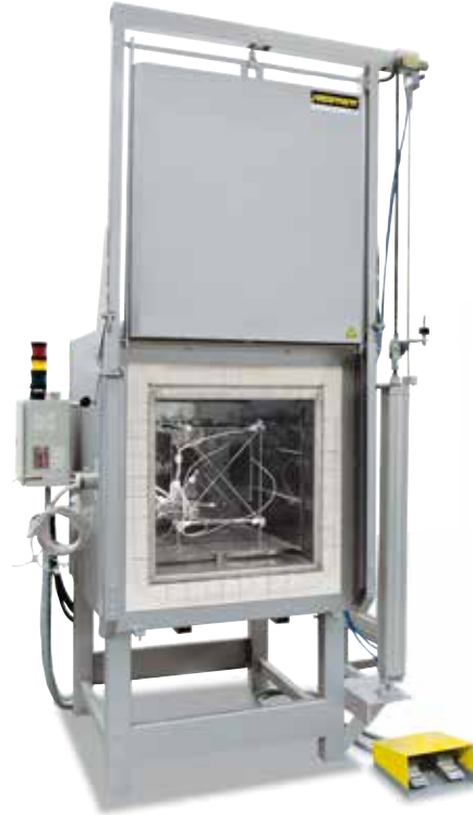
Isı düzgünlüğünün belirlenmesinde kullanılan ölçüm sehpa'sı
