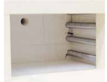
Fırın haznesi çok değerli hafif tip ateş tuğlası tecrit malzemesi ile donatılmıştır.
