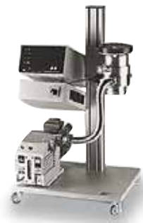
Vakum pompa standı donanımı 10^{-5} mbar değerine kadar olan uygulamalar içindir.
