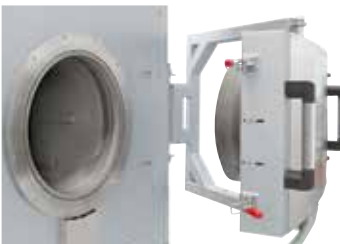
Ek donanım olarak kızgın durumda açmaya yarayan paralel döndürmeli kapak
