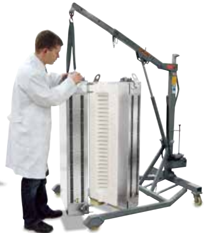
RS 120/1000/11S iki parçalı olarak imal edilmiştir. Her iki fırın yarısı bir birine benzer tasarlanmış olup, müşterinin işletmesinde bulunan bir gaz ısıtma sistemine entegre edilecektir.
