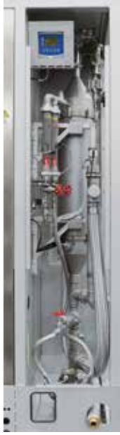
Oluşan proses gazlarının yıkama yöntemiyle temizlenmesini sağlayan atık gaz yıkama ünitesi
