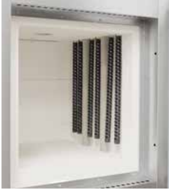
Dikey olarak asılı olan SiC çubukları
