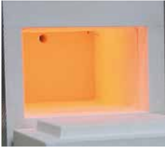
Kalıp 4 tarafından da ısıtılmaktadır
