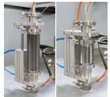
Termoeleman, Tip S, alt sıcaklık aralığında çok iyi kontrol sonuçları için otomatik dışarı çekme düzenekli
