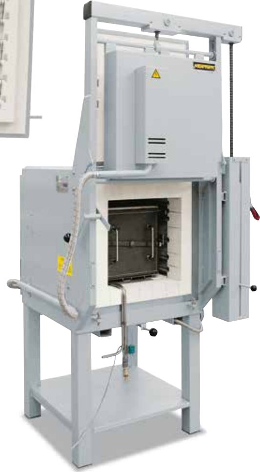
Yanıcı olmayan soygaz veya reaksiyon gazı için manuel lift kapaklı LH 60/12 ve gaz besleme kutusu
