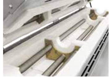
RS 120/1000/11S, üç bölümlü, sıcaklık değerinin elde edilmesi için bölüm ayırmalı
