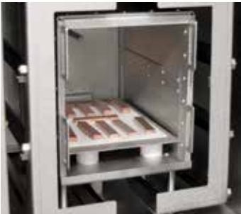
Bakır çubukların hidrojen altında, VHT 8/16-MO içinde ısıl işlemi
