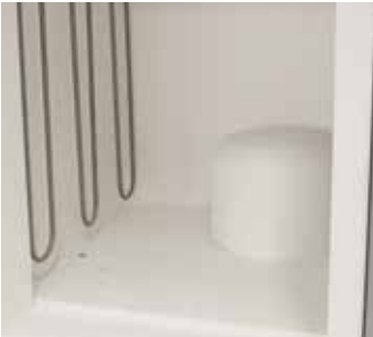
Fırın tabanı üzerinden gerçekleşen gaz beslemeli proses çalışma kapağı fırın bölümünü kirlenmeye karşı korur veya şarj ve rezistanslar arasında etkileşim gerçekleşmesini engeller
