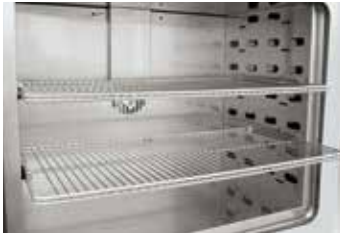
Kurutma dolabının çeşitli düzlemlerde yüklenmesi için, dışarıya çıkartılabilir ızgaralar
