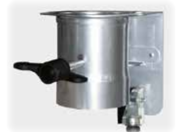
Azami 300 litrelik kapasiteye sahip hazneli fırınlarda kalan kurutma işlemi için yarı otomatik hava giriş kapağı. Ön ayarlı sıcaklık değerinde kapak otomatik olarak kapanır. Kurutma safhasından sonra hava girişinin elden kapatılması gerekmez.
