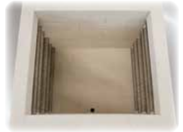
Taşıyıcı borular üzerinde bulunan rezistanslar serbest bir ısı ışınlamasını sağlar
